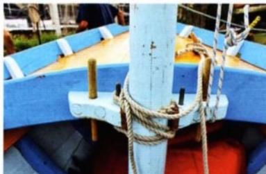
De haut en bas : le coqueron arrière ouvert délimité par une guirlande de frêne ; l'arrière avec sa banquette et ses pailotes (planchers) en pin laricio ; l'une des portières ; l'étambrai et ses cabillots.
